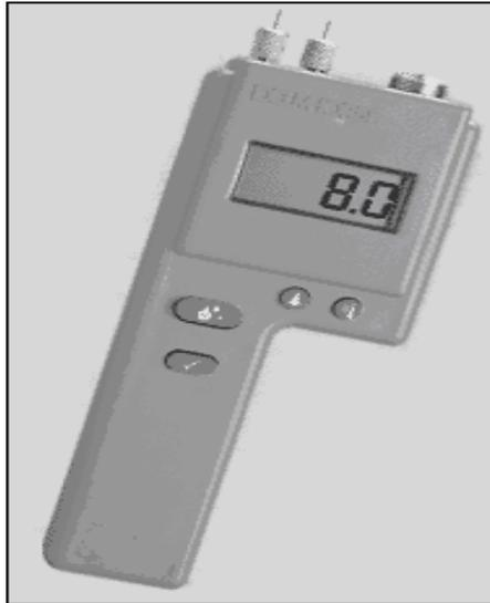
Figura 5. Xilohigrómetro de conductividad eléctrica
