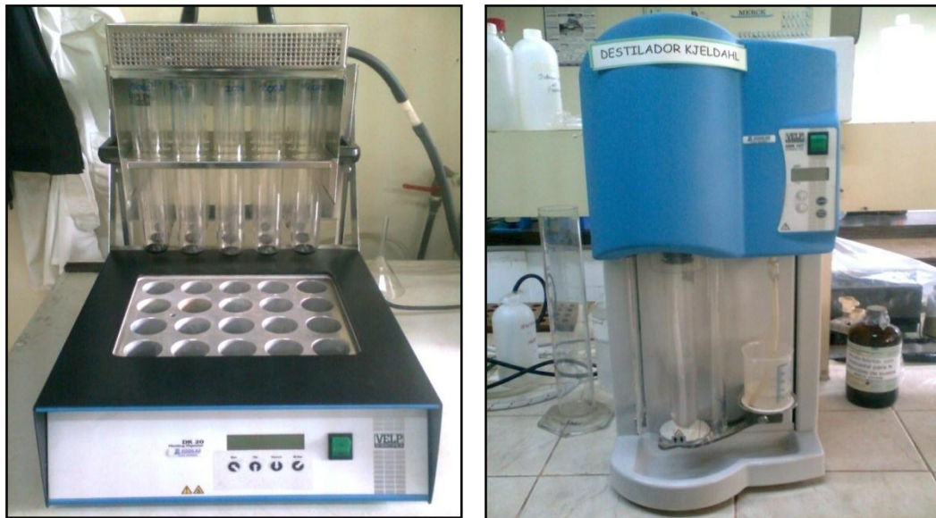
Figura 3.2. Digestor Kjeldahl (izquierda), destilador Kjeldahl (derecha).
