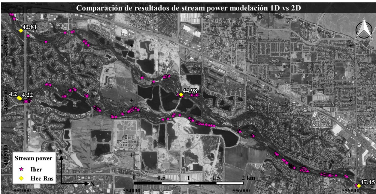
Figura 4.10. Sección del río Boise modelada bidimensionalmente con puntos en los cuales se obtuvieron los máximos gradientes de stream power a partir de modelaciones 1D y 2D. Proyección: WGS84 / UTM zona 11N.
