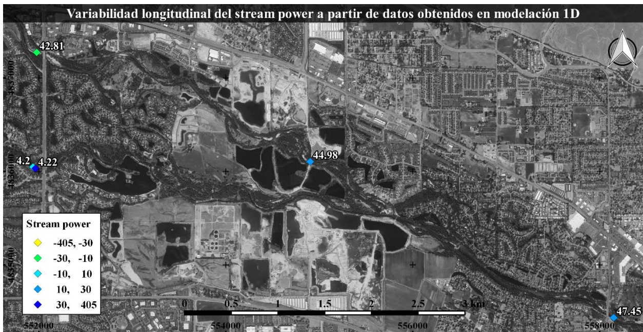
Figura 4.2. Secciones transversales situadas en zona de estudio para modelación 2D, con resultados del gradiente longitudinal de stream power en secciones, sin considerar los valores comprendidos entre -2 y 2 \text{ [kg/m s}^3] . Proyección: WGS84 / UTM zona 11N.
