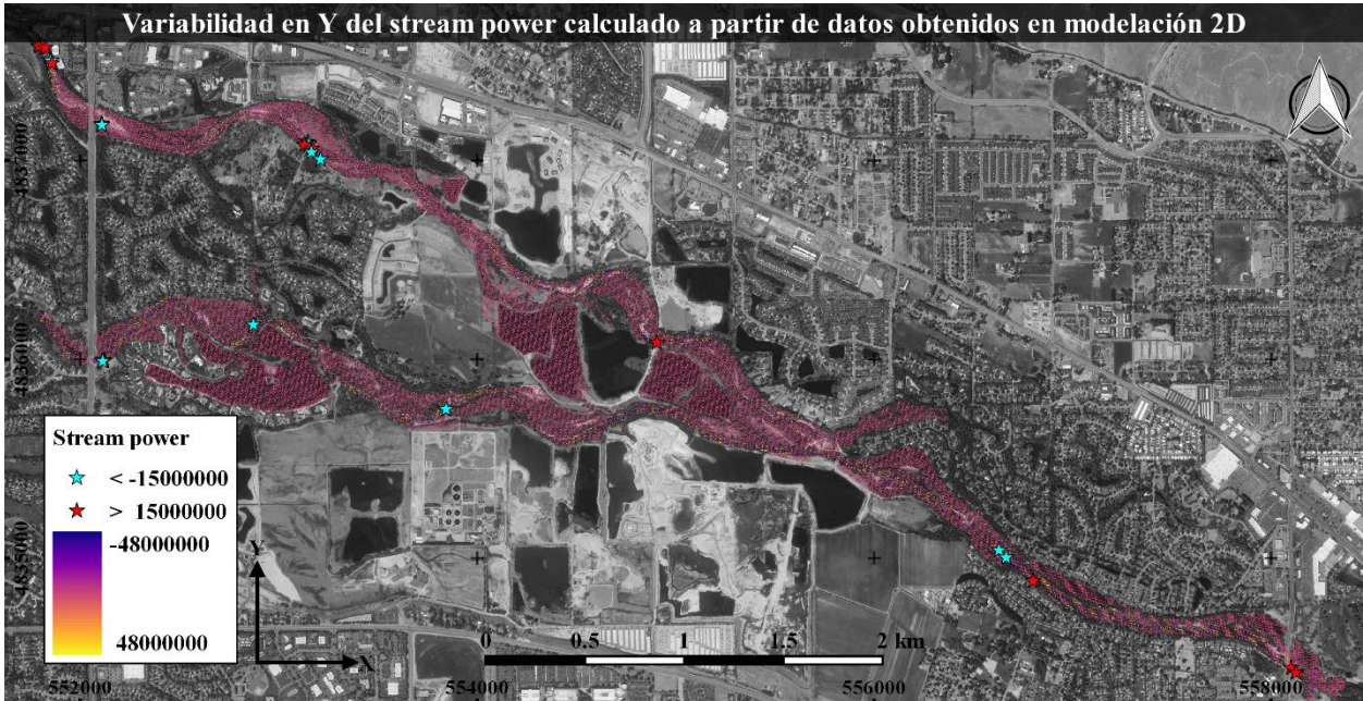
Figura 4.9. Gradiente de stream power en [\text{kg m/s}^3] en dirección Y con puntos máximos y mínimos. Proyección: WGS84 / UTM zona 11N.
