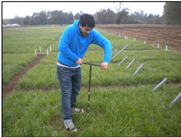
**Figura 3.4:** Muestreo de suelo con barreno geológico.
