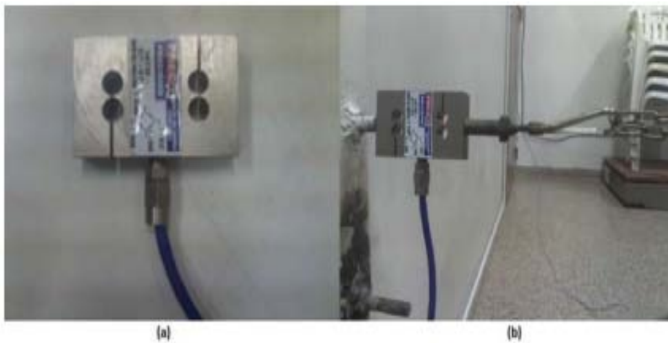
Figura 8.- Sensor del dinamómetro sin conectar, (a) sensor atornillado y (b) trabajando a tracción
