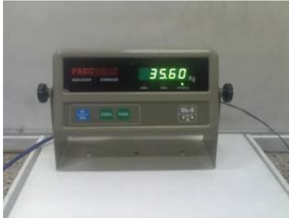
Figura 7.- Pantalla y controles del dinamómetro isométrico
