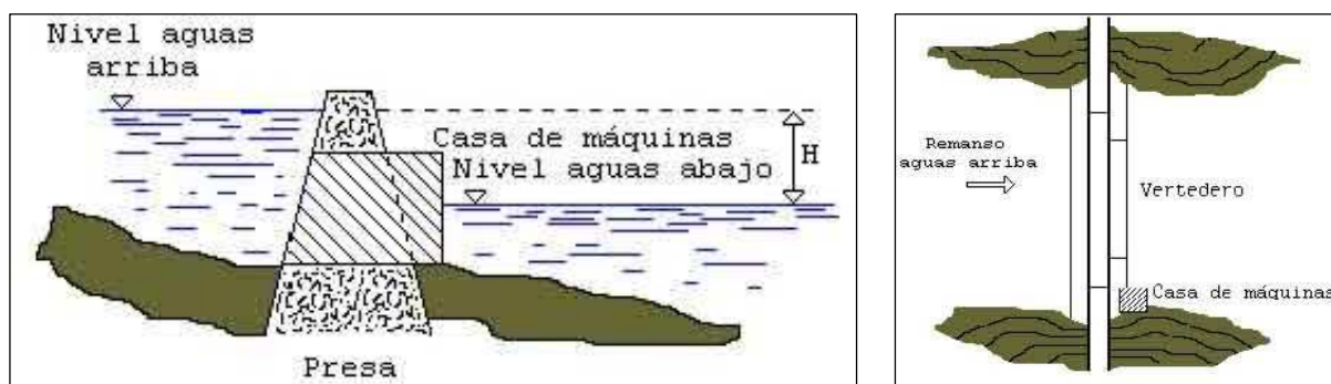
Figura 4. Esquema de una central hidroeléctrica de pasada 11 .
