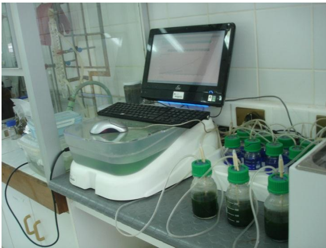
Figura 10: Sistema de medición de biogas Bioprocess control.
