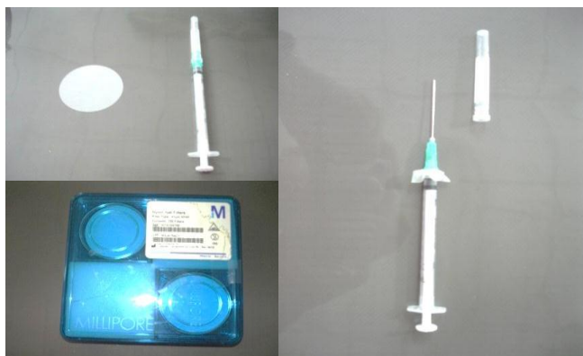
Figura 9: Imagen que muestra cómo se disponen los filtros en la jeringa de 1 ml.
