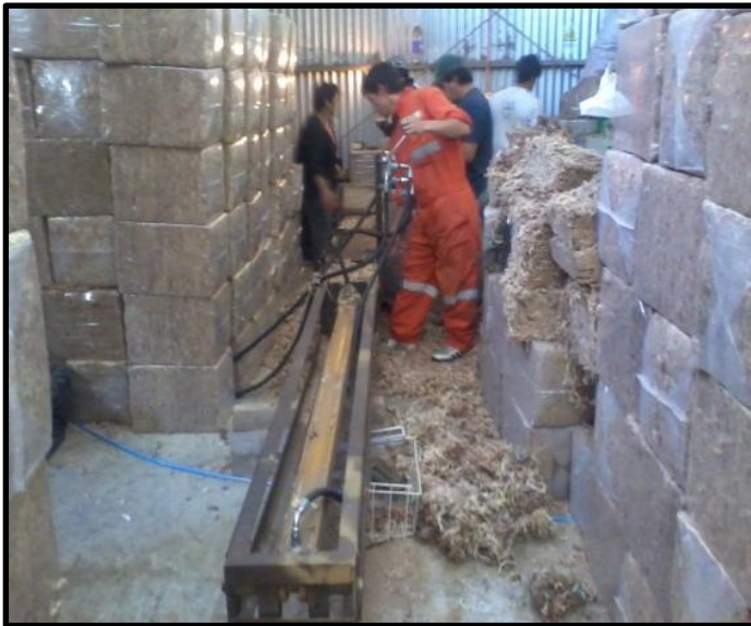
Figura15. Prensa metálica, de acción manual para fabricar bloques de musgo, correspondiente a formatos de 5 Kg (foto del autor)
