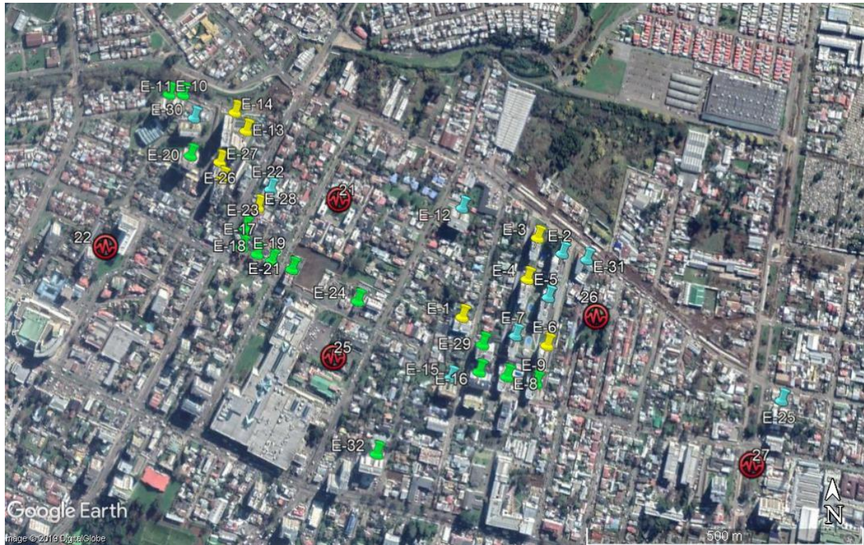
Figura 5.25. Emplazamiento de los edificios de la muestra y de los puntos de medición del periodo fundamental del suelo.
