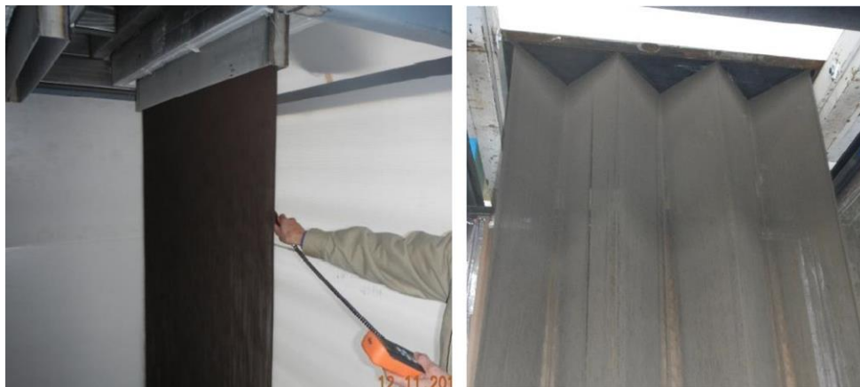
Figura 3.15. Cascada de partículas utilizada como HTF en receptor solar (Ho, 2017)
