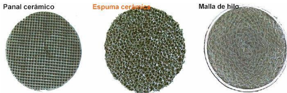
Figura 3.7. Muestras de materiales porosos para receptores de plantas CSP de torre central (de La Lastra Pérez, 2010)
