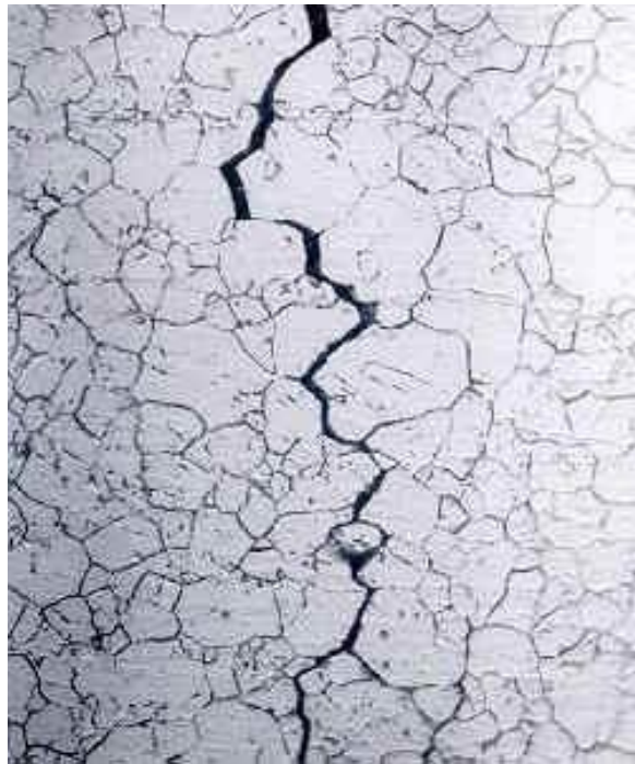
Figura 4.14. Micrografía (500x) que muestra SCC intergranular de un tubo intercambiador de calor de Inconel con la grieta siguiendo los límites del grano (NACE International, 2020)
