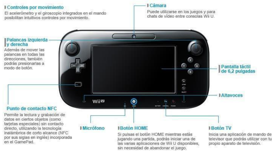
Figura 4: Gamepad y sus componentes, consola Nintendo Wii U, vista frontal.
