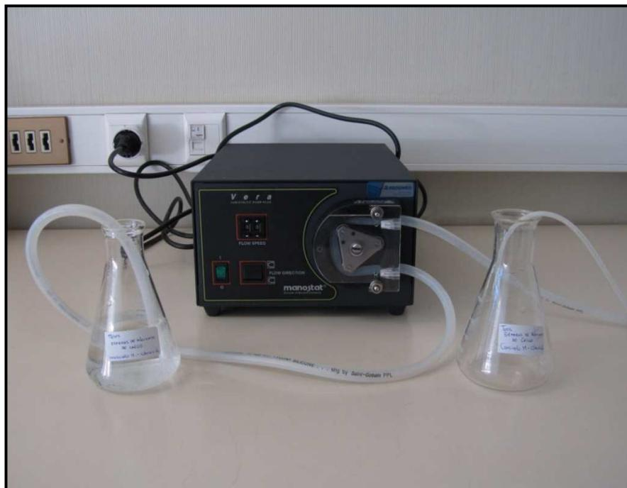
**Figura 8.** Bomba peristáltica y matraces para la elaboración de esferas de alginato de calcio.
