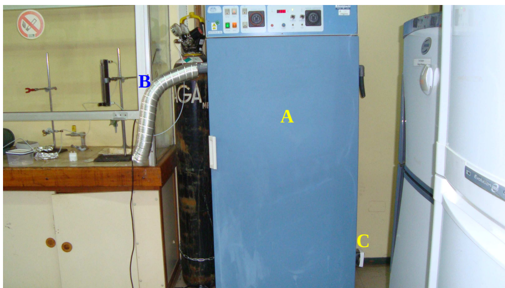
Figura 3. Sistema de liberación controlada de semioquímicos: A) Cámara de cultivo, B) Tubo de ventilación conectado hacia una campana de extracción, y C) Ventilador.
