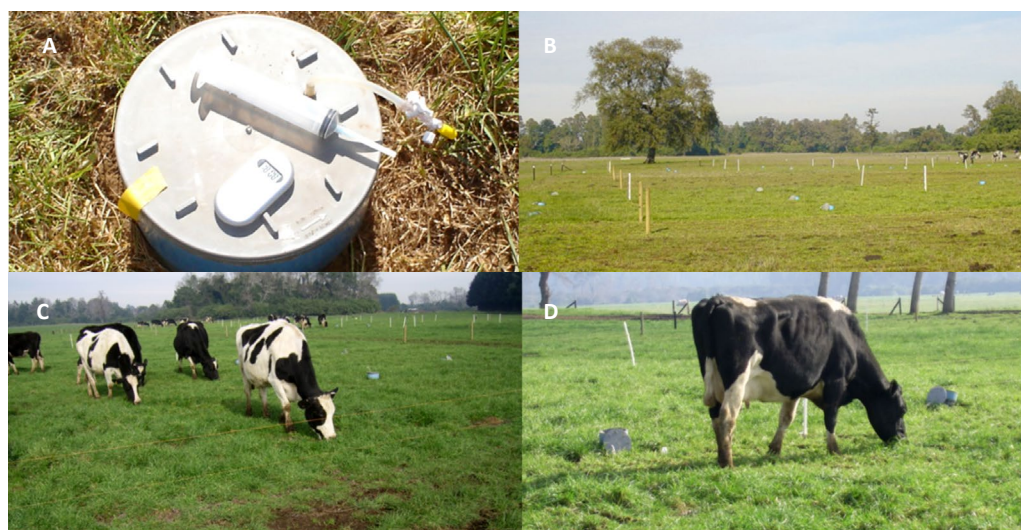
Figura 7.10. Mediciones de campo A. Cámaras estática de PVC hermética, jeringa y cronometro para el muestreo de gases en campo; B. Distribución de cámaras y lisímetros en campo para medir pérdidas de N; C. Vacas Holstein Friesian en pastoreo; D. Animal de 400 kg pastando en una pradera polifítica del sur de Chile junto a cámaras de PVC y lisímetros.
