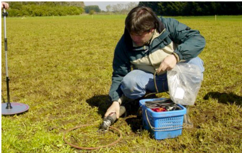
Figura 9.14. Calibración del rising plate meter utilizando un anillo y máquina esquiladora modificada para cortar la pastura.
