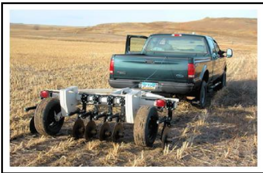
Figura 8. Medición de Conductividad Eléctrica Aparente del suelo con el equipo Veris 3100®, como se observa los discos están a unos pocos centímetros de profundidad (Fuente: Veris Technologies).
