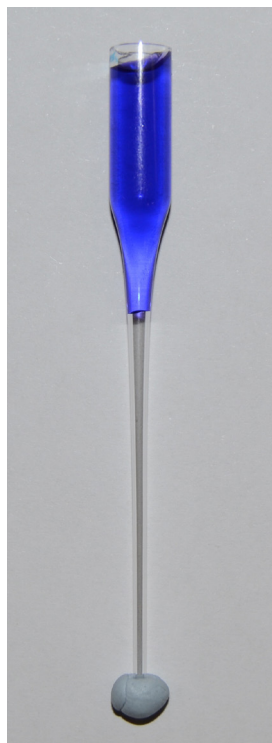
Figura 7.6. Modelo de pipeta Pasteur modificada, propuesto para el estudio del efecto antimicrobiano de la irrigación activada por láser. El extremo superior representa la cámara pulpar con el irrigante en su interior. El extremo inferior representa el canal radicular, donde se encuentran adheridas las bacterias. Nótese que el irrigante no inunda el extremo inferior, debido a la acción del adhesivo estéril (Imagen: Dr. Betancourt).
