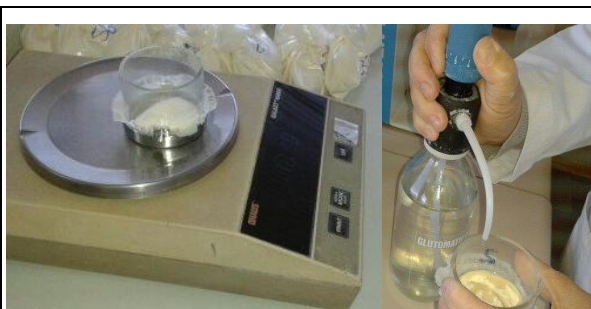
Pesaje y aplicación de Cloruro de sodio
