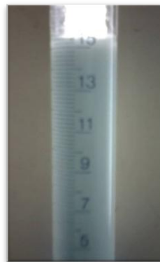
Solución de harina, ácido láctico y azul de bromofenol en probeta graduada.
