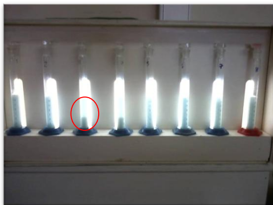
Lectura del volumen de sedimentación, expresado en ml.
