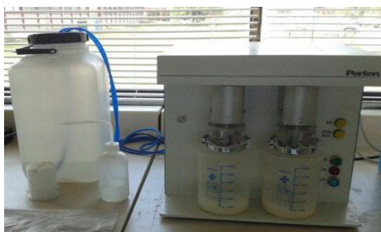
Cámara de lavado
