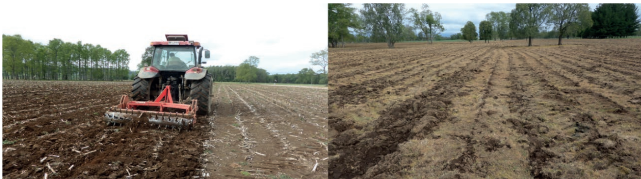
Paso de arado subsolador que permite la descompactación del suelo y la exploración radical del maíz en el suelo.
