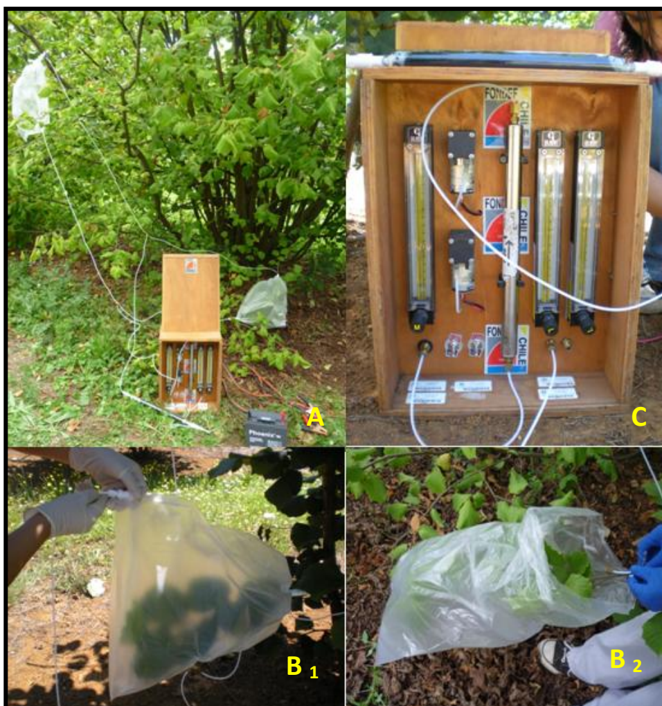
Figura 6. Sistema de atrapamiento de volátiles. A) Sistema colectando volátiles de avellano europeo, B 1 ) sello de teflón, B 2 ) tubería teflón, C) Sistema de bombas.
