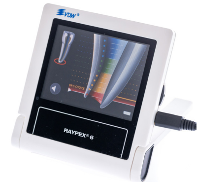
Figura 8.12. Este equipo muestra el cierre del circuito con la última línea roja, indicando que la lima se encuentra en contacto con el periodonto.
