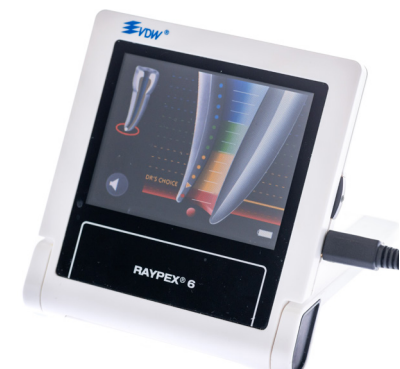
Figura 8.13. Una vez traspasada la constricción apical este LAE nos indicará un mayor contacto con el periodonto mostrando un círculo rojo en la imagen de la derecha.
