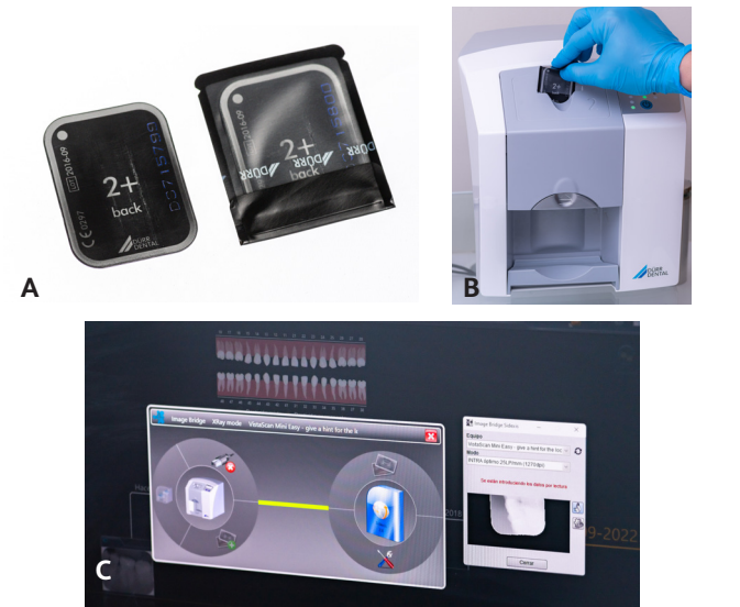
Figura 3.9. A. Sensor. B. Lector láser. C. Monitor donde se observa la imagen.
